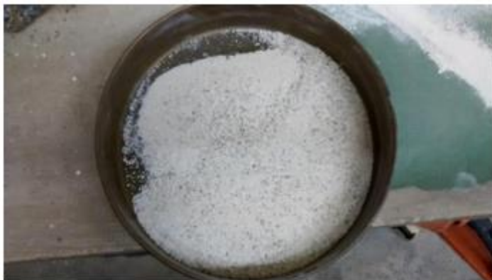
Figura 9 - Resultado da trituração da concha.
