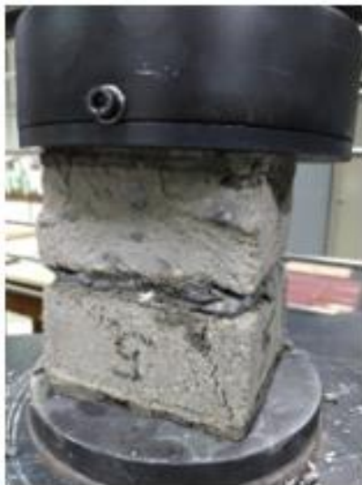
Figura 7: Tijolo rompido após a aplicação da carga axial.
