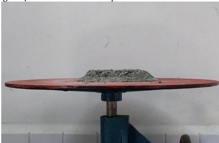
Figura 4: Ensaio de determinação do índice de consistência.
