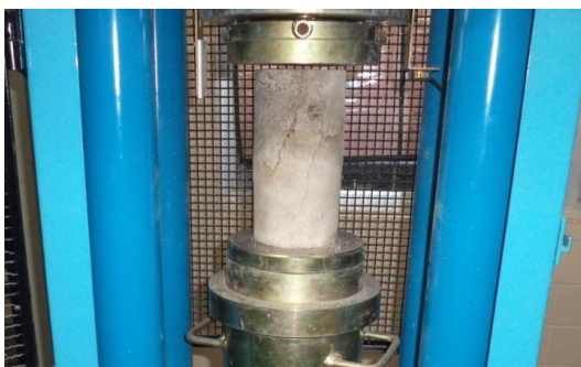
Figura 10 - Ruptura após aplicação de carga de compressão axial
