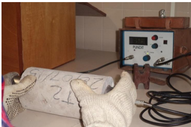
Figura 12: Ensaio para determinação da velocidade de propagação da onda ultrassônica.
