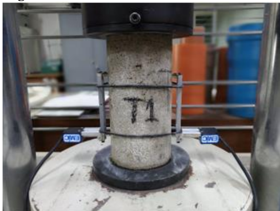
Figura 8: Ensaio de módulo de elasticidade.
