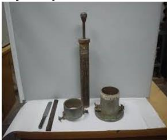
Figura 1: Soquete e Cilindro Proctor Normal.
