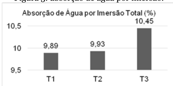
Figura 5: absorção de água por imersão.
