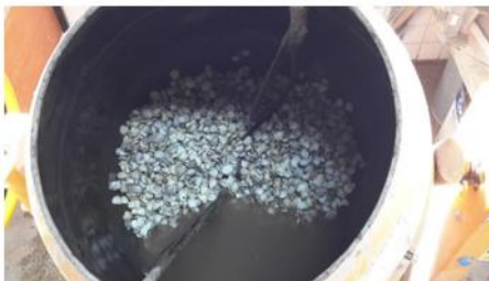
Figura 7: Lavagem das conchas em Betoneira.
