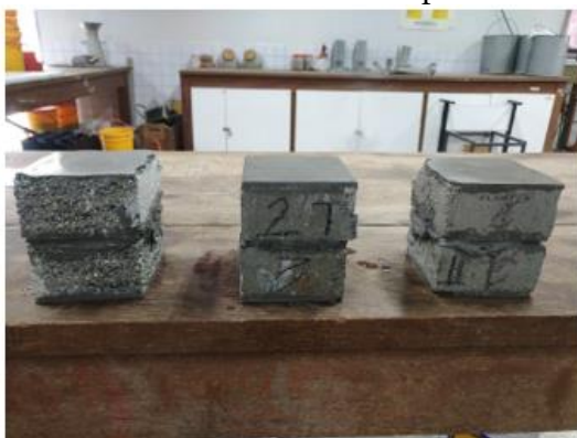
Figura 6: Preparação dos tijolos para o ensaio de resistência à compressão.
