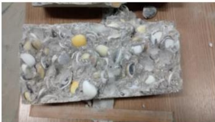
Figura 12 - Corpo de Prova Rompido Diametralmente.
